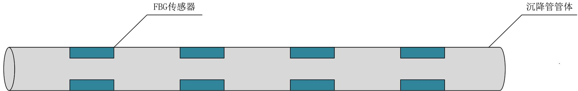
沉降管每根为固定长度（1~3米）在布置时可以将多根沉降管进行拼接，实现隧道长距纵向变形监测或者建筑地基沉降监测。对高层建筑而言，沉降一般会引发结构倾斜，因此将沉降数据和倾斜数据综合分析可以对建筑状态进行评估。
